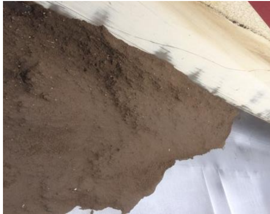
Figure 3 : Terre mouillée collée sur la benne (photo par Hoslet, DTM)
