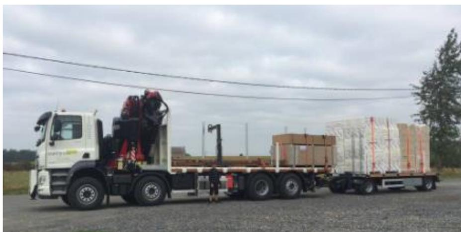
Figure 13 : Camion grue 65 tonnes
