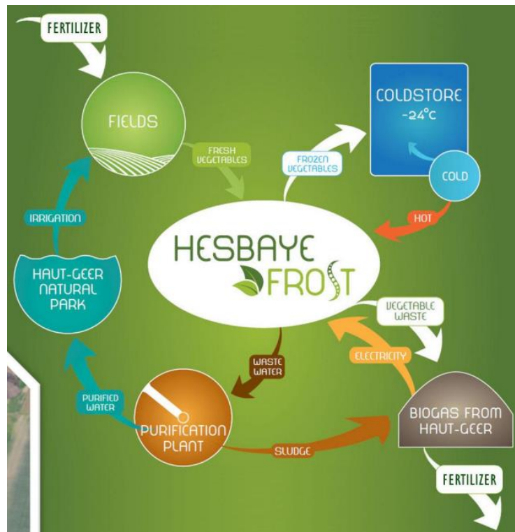
Figure 6 : Schéma du cycle de recyclage des eaux usées et des déchets chez Hesbaye Frost
