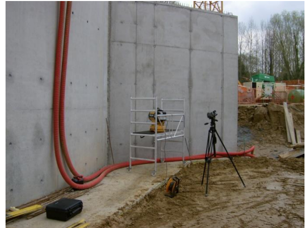
Fig. 7: Essais réalisés sur des chantiers de stations d'épuration. L'image infrarouge met en évidence la présence d'un défaut interne de type nid de gravier.
