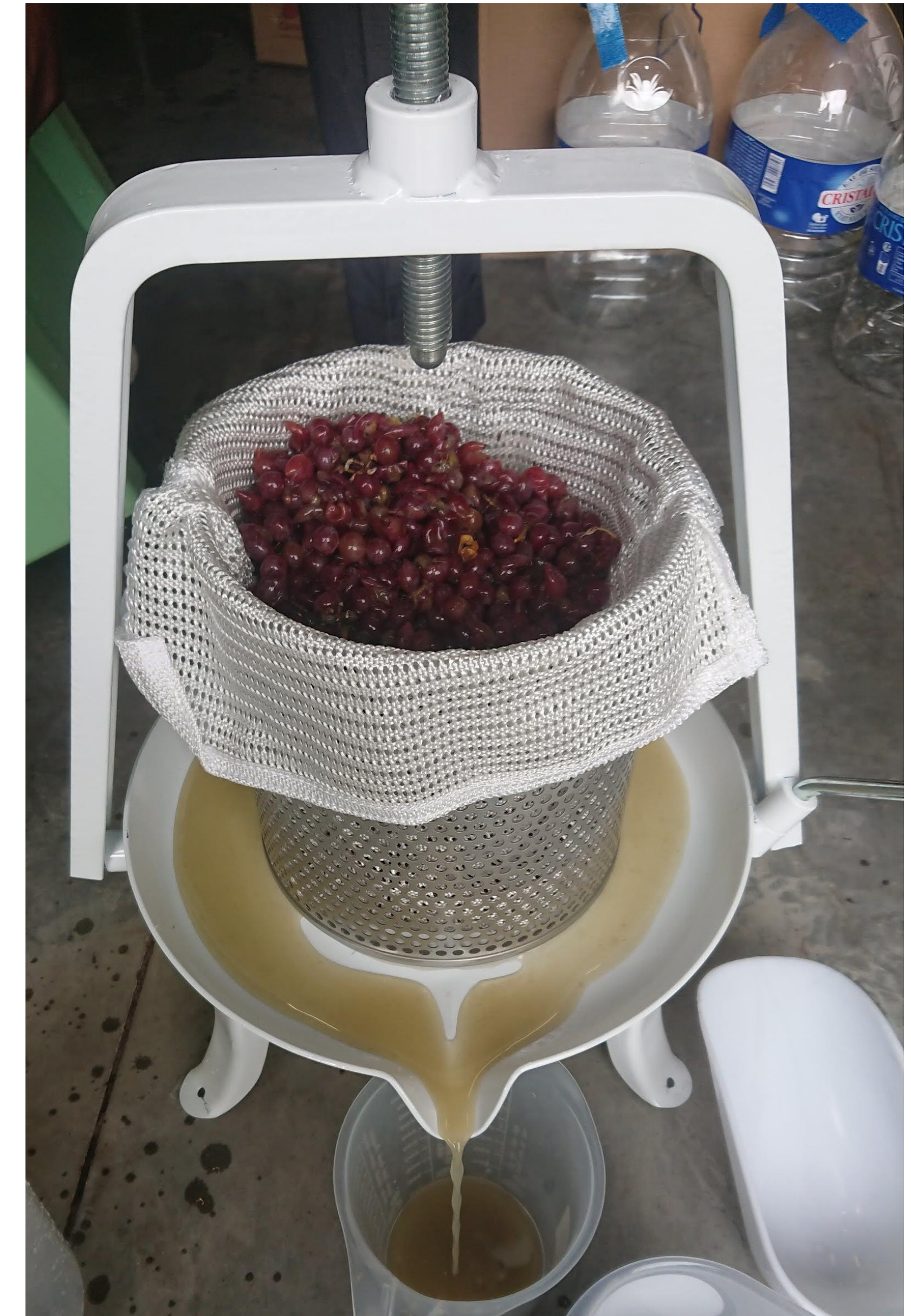
Figure 2. Pressage des raisins pour obtenir un moût à fermenter en vin blanc.
