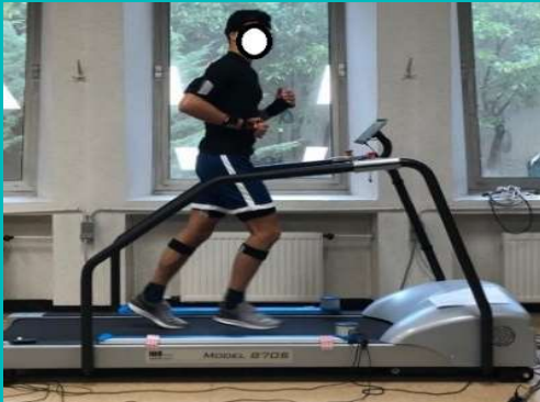
Figure 1 : Sujet équipé des capteurs inertiels Xsens-MT Awinda®
