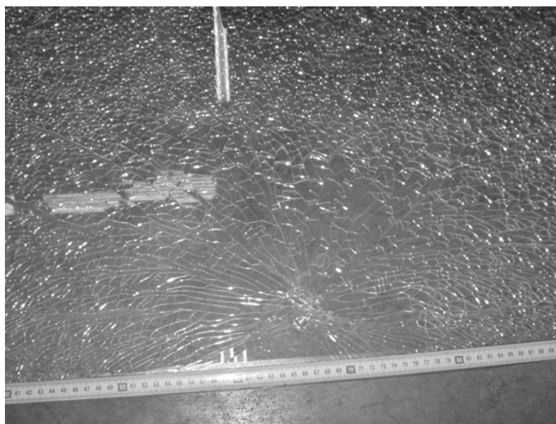
Figure 9 : Fragmentation obtenue sur un volume de verre trempé
