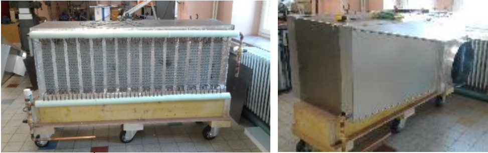
Figure 10 : Échangeur couvert par l'isolant (gauche), puis enveloppé dans la gaine
