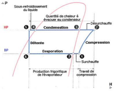
Figure 2 : Diagramme pression-enthalpie d'un cycle frigorifique [8]
